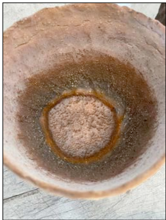
Et eksempel med kryolitens virkning på leret
