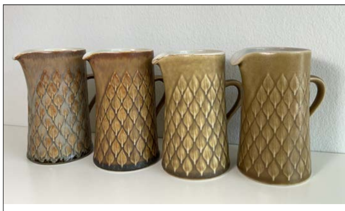
Relief-flødekander brændt i forskellige ovne: De første to fra venstre er brændt i de små enkubikmetersovne fra fajancetiden. Den næste er brændt i kanalovnen, og den sidste i tunnelovnen
